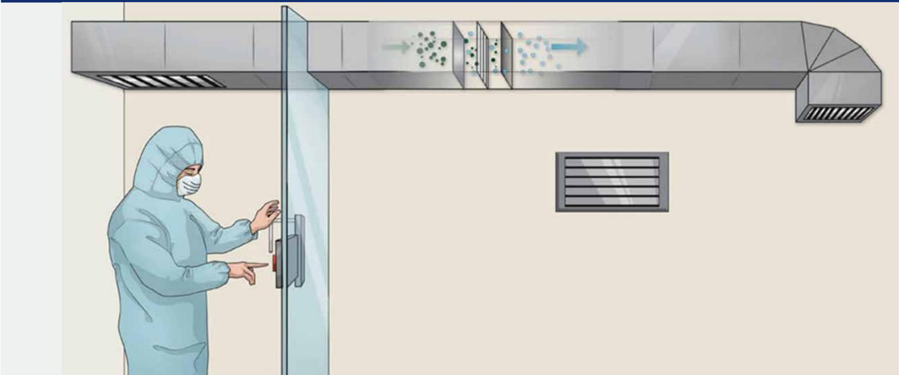
Ilustración 3 Esquema de filtros de aire de alta eficiencia en SVL
