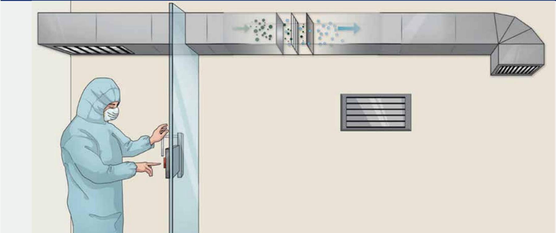
Ilustración 2 Esquema de filtros de aire de alta eficiencia en SVL
